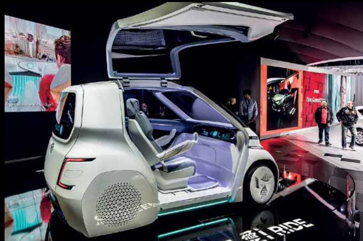
TOYOTA FINE-Comfort Ride – ūdeņraža šūnu auto nākotnes vīzija, kura signalizē par virzienu, kādā varētu veidot nākamās paaudzes Toyota FCEV (Fuel Cell Electric Vehicle) automobiļus. Uzsvārs uz dizainu, komfortu un apjomīgāku interjera telpu, ko nodrošina elektrodzinēji, kas izvietoti tieši riteņos. Pievēršam uzmanību sēdekļiem – jauns un stilīgs risinājums!
