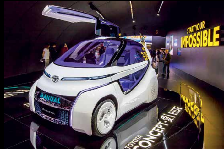
TOYOTA FINE-Comfort Ride – ūdeņraža šūnu auto nākotnes vīzija, kura signalizē par virzienu, kādā varētu veidot nākamās paaudzes Toyota FCEV (Fuel Cell Electric Vehicle) automobiļus. Uzsvārs uz dizainu, komfortu un apjomīgāku interjera telpu, ko nodrošina elektrodzinēji, kas izvietoti tieši riteņos. Pievēršam uzmanību sēdekļiem – jauns un stilīgs risinājums!
