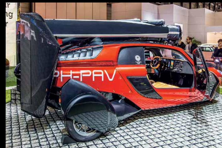
PAL-V Liberty. Iespējams, pasaulē pirmā komerciāla un sertificēta lidojošā automašīna, kas tiks piegādāta pirmajam klientam nākamgad. Prezentēta pagājušajā gadā. Tas nav auto un helikoptera krustojums, bet gan žiroplāns, kuram lielo rotoru iegriež (pret)vējš, bet uz priekšu virza propelleris gondolas aizmugurē. Lai iestātos rindā, jāiemaksā 10 000 EUR par lētāko modeli vai 25 000 EUR par īpašo atklāšanas sērijas Pioneer modeli, kas maksā 499 000 EUR salīdzinājumā ar 299 000 par "bāzīti", kas gan būs jāgaida ilgāk. Ir zināmas aizdomas, ka šo "Karlsonu" nav nemaz tik viegli iemācīties vadīt, sorry, – pilotēt. :)
