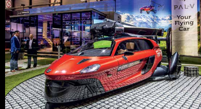
PAL-V Liberty. Iespējams, pasaulē pirmā komerciāla un sertificēta lidojošā automašīna, kas tiks piegādāta pirmajam klientam nākamgad. Prezentēta pagājušajā gadā. Tas nav auto un helikoptera krustojums, bet gan žiroplāns, kuram lielo rotoru iegriež (pret)vējš, bet uz priekšu virza propelleris gondolas aizmugurē. Lai iestātos rindā, jāiemaksā 10 000 EUR par lētāko modeli vai 25 000 EUR par īpašo atklāšanas sērijas Pioneer modeli, kas maksā 499 000 EUR salīdzinājumā ar 299 000 par "bāzīti", kas gan būs jāgaida ilgāk. Ir zināmas aizdomas, ka šo "Karlsonu" nav nemaz tik viegli iemācīties vadīt, sorry, – pilotēt. :)
