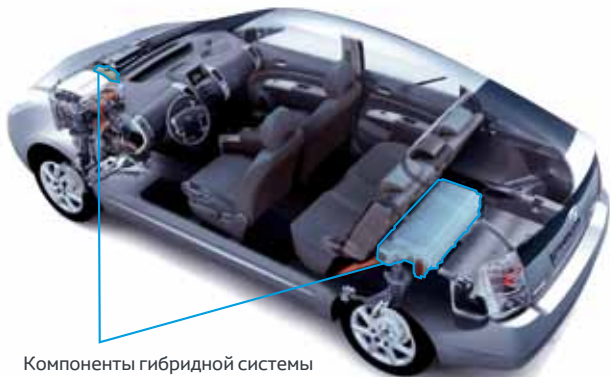
Компоненты гибридной системы
