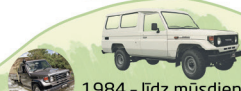
1984 - līdz mūsdienām Land Cruiser 70 - IV paaudzes mazais modelis, ievērojamā cietība, jo atsevišķos reģionos tas tiek ražots vēl šodien un ir pēc pasūtījuma noperkams arī dažās Eiropas valstīs, no 2007. gada tam tiek uzstādīts pat V8 dzinējs. Tika ražots gan klasiskajā, gan pikapa vai "light truck" versijā.
