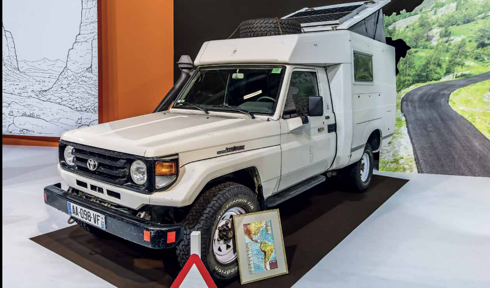
TOYOTA LAND CRUISER HZJ 79 , 2006. gada modelis, 6 cilindru dizelis, bloķējami priekšējais un aizmugurējais diferenciālis, komplektācija bez elektroniskām ierīcēm, kuras varētu tikt bojātas brauciena laikā īpaši skarbo ceļa apstākļos. Ar šo automašīnu laika posmā no 2009. gada novembra līdz 2011. gada janvārim ir veikts 63 700 km garš pārbrauciens no Ušvajas ( Ushuaia ) Argentīnā, Dienvidamerikā līdz Kanādai Ziemeļamerikā. Augstākais punkts, kuru pārvarējis šis „kruizeris” – 5040 metri virs jūras līmeņa Bolīvijas augstkalnu plato.
