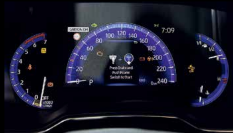
Dalēji digitāls mērinstrumentu bloks ar integrētu ekrānu.
