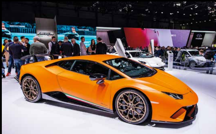
Lamborghini Huracán Performante. 640 Zs un 600 Nm. Pašmasa tikai 1382 kg – 2,15 kg/Zs.
