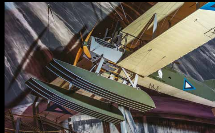
Hidroplāns Short Type 184. Izmantots izlūkošanai vai kā bumbvedējs un torpēdnēsējs.
