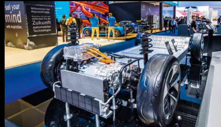
Tiggo Coupe Concept EV System. Pasaulē labi zināmā Cherry pieteikums elektromobiļu laucīnā. Pietiek, ja reizi esat redzējuši Tesla “šasiju”, lai nojaustu, ka zināma līdzība te pastāv. Tikai Ķīnā ir tuvu 1,4 miljardiem iedzīvotāju, un šis koncepts var uzlādēt savu 75 kWh baterijas līdz 80% nieka 30 minūtēs, nobraukt 500 km un 0-100 km/h sasniegt 7 sekundēs. Nav slikti?
