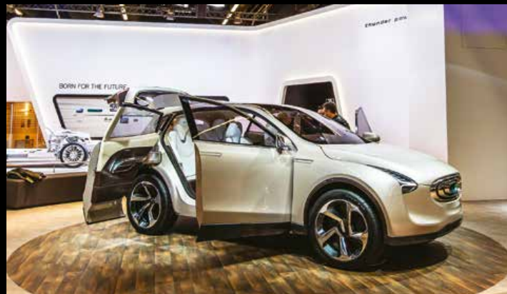
Ķīna nāk. Thunder Power. 650 km ar vienu uzlādi, 125 kWh baterija, jauda līdz 430 kW, Milānā tapis dizains. SUV Future Vision Alpha ir koncepts jeb – kā uzņēmums to prezentē – sākotnējais braucošais prototips. Ražotne atrodas Ganzhou Economic and Technological Development Zone Ķīnā. Uz jautājumu par Eiropu dzirdējām atbildi, ka tiek celta rūpnīca Katalonijā.
