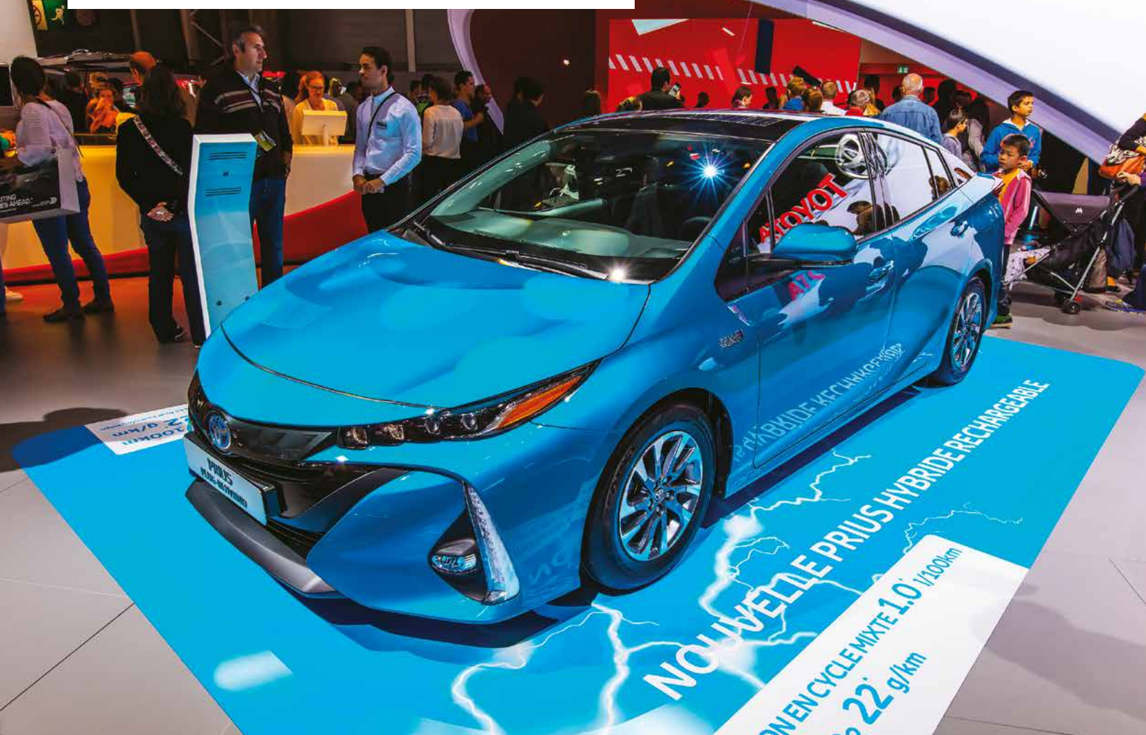
Toyota Prius Plug-In Hybrid izskatās dārgāk un ir dārgāks par parasto Prius. Tikai ar akumulatoru bateriju auto var nobraukt līdz 50 km, sasniedzot ātrumu līdz 135 km/h, kas ir pilnībā pietiekami pilsētas ciklam.
