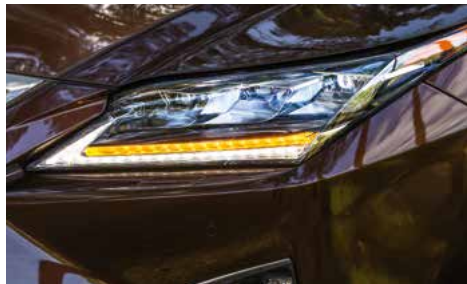
Viena no jaunā Lexus RX odziņām – sekvenciālie LED pagriezienu rādītāju signāli, kas pēc iepriekš sastādītas un sistēmā saglabātas programmas plūst norādāmajā virzienā. Hipnotisks efekts, kuru var aplūkot vēl un vēl
