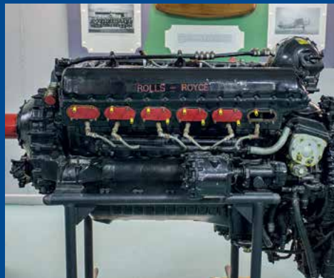
Rolls Royce Merlin V-12 aviācijas dzinējs. Pirmās paaudzes (1934) dzinējiem sākotnēji bija 790 Zs jauda, bet otrās paaudzes – līdz 2050 Zs (1944). Saražoti > 160 000 gab.
