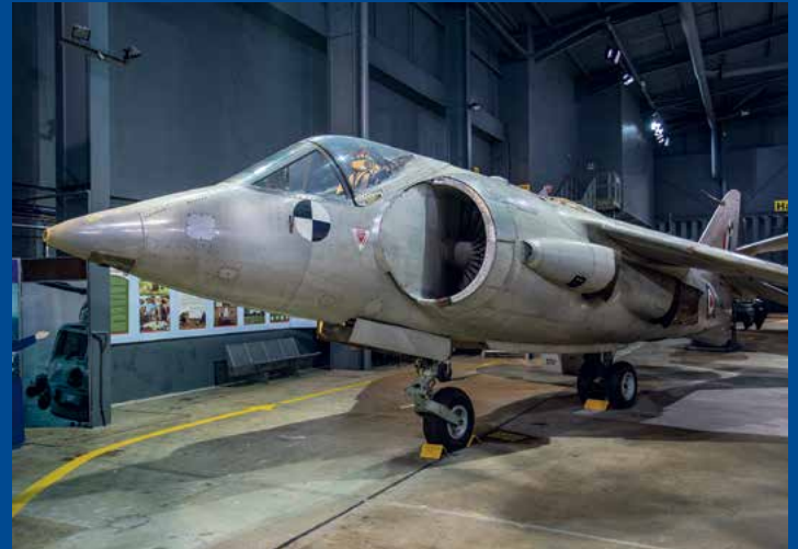
Eksperimentālais vertikālās pacelšanās un nolaišanās lidaparāts XP980 Hawker P1127 , izgatavots 1963. gadā, kad veica pirmo lidojumu. Kopumā izgatavotas 6 šādas lidmašīnas, kas ļāva britiem izstrādāt sērijveida revolucionāro Sea Harrier iznīcinātāju.
