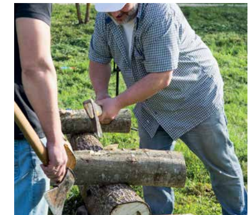
Gropiņu veidošana tuvplānā. Šis darbs jāveic ar maksimālo precizitāti un jānomēra tā, lai veidotos vienāds konuss...
