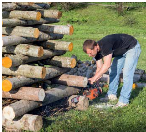
Sākam izdaiļošanas pirmo posmu - balķu galu apgriešanu lenķī. Lenķim, protams, jābūt vienādam!
